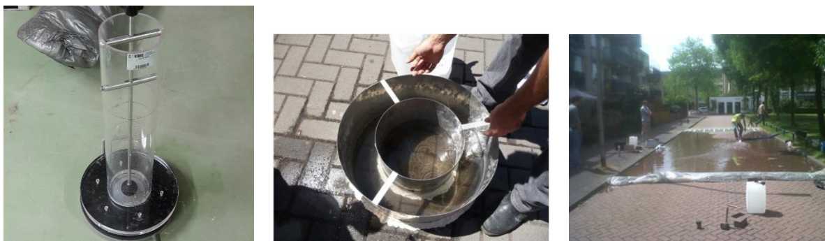
Figuur 16, 17 & 18: Voorbeelden van methodes voor infiltratiecapaciteit metingen (Bron: J. Advokaat ; mdpi.com; mdpi.com)
