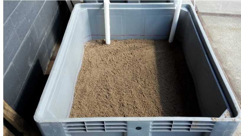
2) Allereerst wordt de bak gevuld met 25 cm zand en worden de peilbuizen geplaatst.
