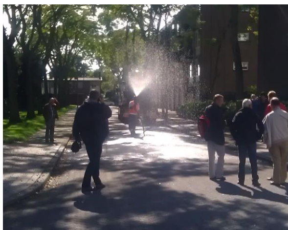
Figuur 20: Praktijktesten door middel van een buisimulatie met een spuitwagen (Bron: Linden, 2016)
