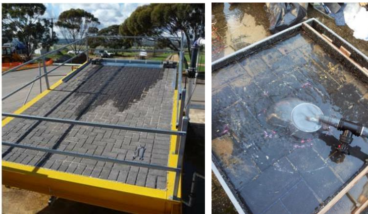
Figuur 25 & 26: Opstellingen van laboratoriumtesten met waterpasserende verhardingen (Bron: Lucke et al., 2012; Boerma & Boogaard, 2012)
