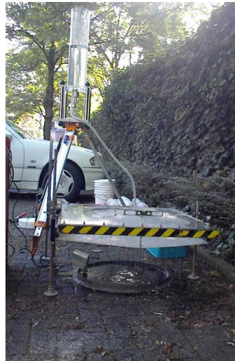
Figuur 19: Praktijktest met de regensimulatie testbank (Bron: Dierkes et al., 2002)
