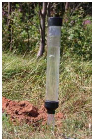
Figuur 2-18: Pask In situ Permeameter
