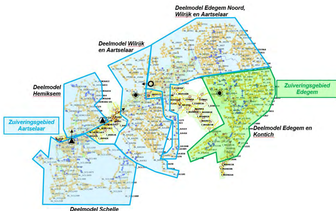
Figuur 4-3: Overzicht rioolstelsel met opdeling in deelstelsels
