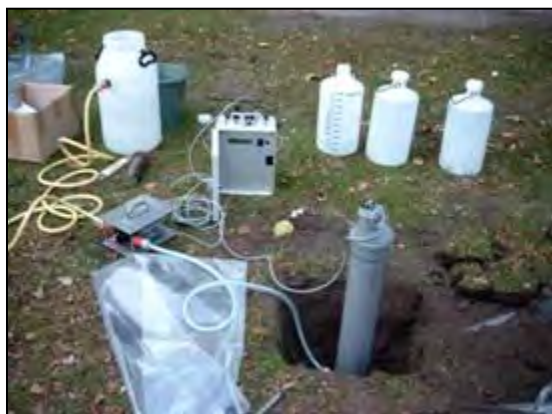
Figuur 2-23: Geautomatiseerde Open-end test met constante waterkolom (bron: OCW)
