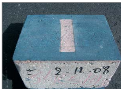
Figuur 3.4 Capontoestel en getest proefstuk
