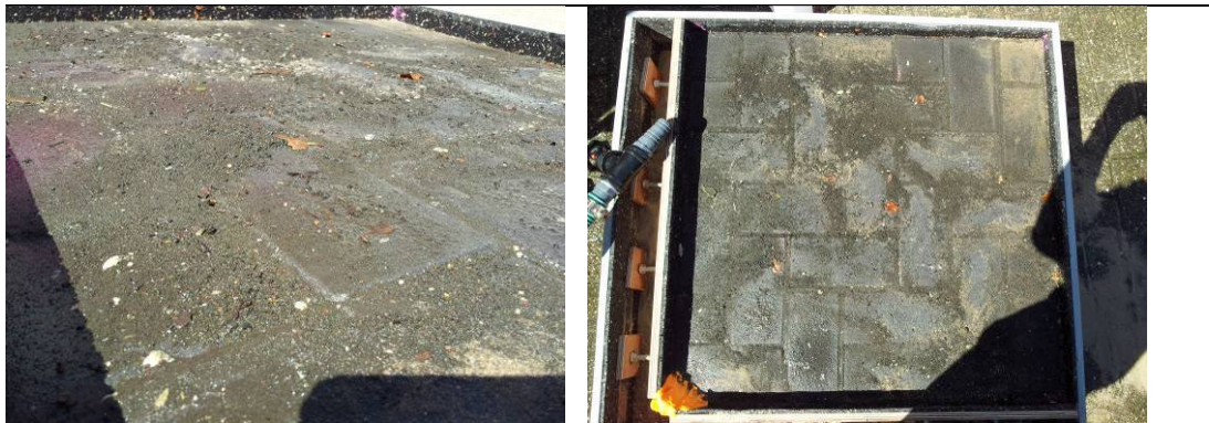
Figuur B1.5 Resultaat na duurttest met straatvuil (2)
