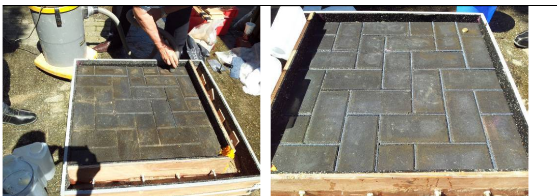
Figuur B1.7 Simuleren zoabreining met stofzuiger (links) en resultaat(rechts)
