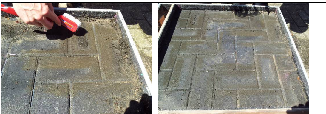
Figuur B1.6 Simuleren straatvegen (links) en resultaat (rechts)
