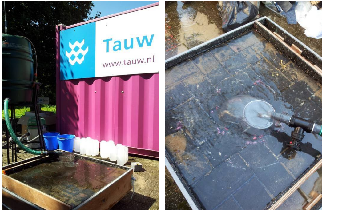
Figuur B1.3 Test opstelling waterpasseerbaarheid
