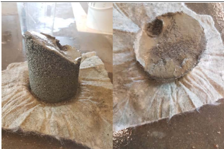
Figuur 3.3 Weergave klei-achtige laag boven- en onder de funderingslaag
